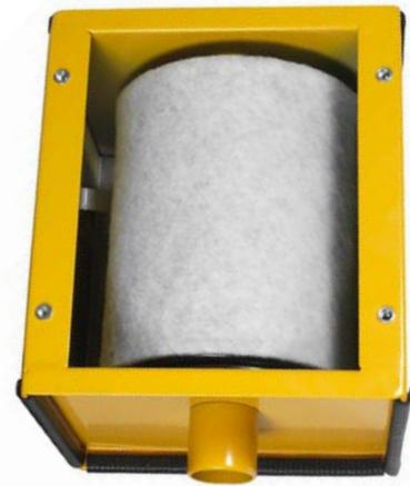
5. Die Filterpatrone dann mit der Bodenseite vor die Klemmschraube setzen und diese bis zum Anschlag anschrauben.
